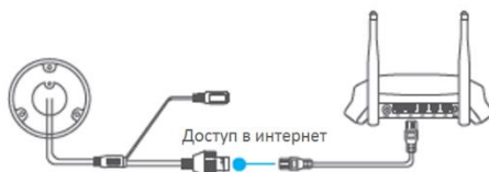
Рисунок 5-3 Подключение к роутеру
